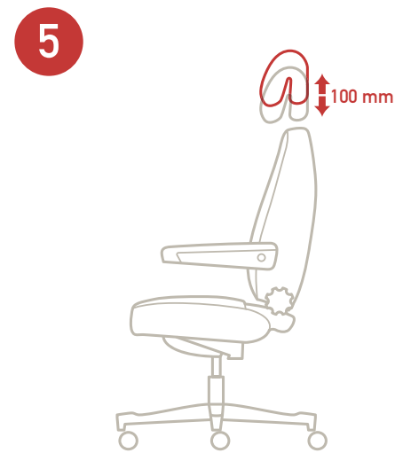
5 Regolazione in altezza del poggiatesta KK (optional). Headrest KK (optional) height adjustment.
